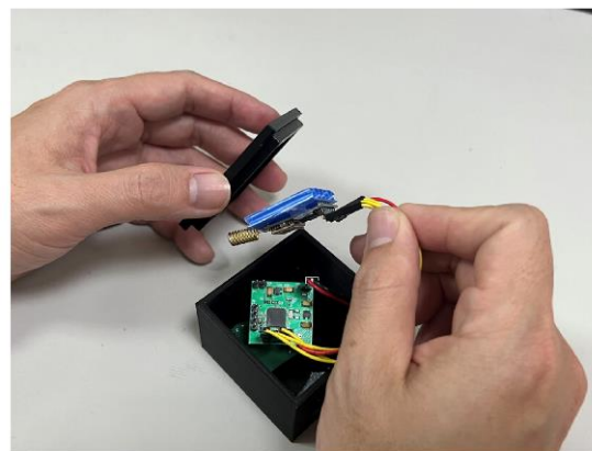
學生比較市面上專為銀髮族設計的跌倒自動通報求救裝置，再運用課堂所學改良研發，設計出嶄新的無線緊急求救系統。
